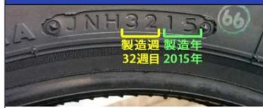
スタッドレスタイヤは製造されてからどの程度時間が経っているかというのが使用限界の目安となります。タイヤの製造時期は、タイヤの横の部分に刻印されています。4桁の数字の部分に製造の時期、前半2桁が製造された週数、後半2桁が製造された年を指します。この場合は2015年の32週目(9月)に製造されたこととなります。
